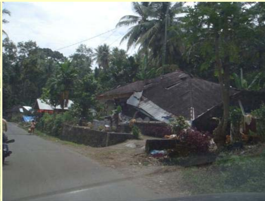
全壊した平屋建ての民家 屋根部は軽量だがレンガの壁が崩れてしまった。 (パリアマン市内 10月6日)
